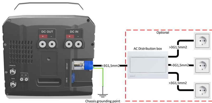
**WARNUNG:** Die Schutzerdung MUSS durch eine Verbindung zwischen Neutrik 230 VAC-Out und Chassis erfolgen.
