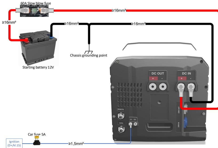
**WARNUNG:** Die Verwendung der falschen Kabelgröße oder eine schlechte Kabelverbindung kann zu Überhitzung und Kurzschluss führen.
