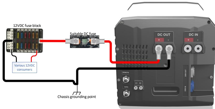
**WARNUNG:** Die Werte der Ausgangssicherung und der Kabelgröße, einschließlich des Erdungskabels, müssen für die verwendete Last ausgelegt sein.
