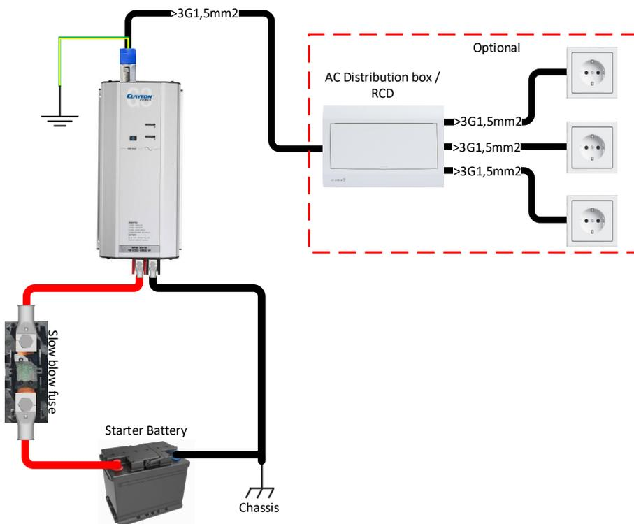
Le schéma suivant illustre la manière de connecter l'onduleur/chargeur G3 lorsqu'il est utilisé en mode onduleur. Les calibres des fusibles sont indiqués dans le tableau ci-dessous.
