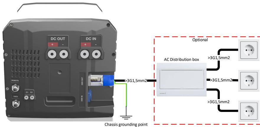
**ADVERTENCIA:** Se DEBE realizar una conexión desde el conector Neutrik 230 VCA Salida al bastidor para la puesta a tierra de protección.
