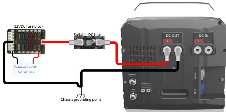
**ADVERTENCIA:** El fusible de salida y el tamaño del cable, incluido el cable de conexión a tierra, deben estar clasificados según la carga que se utilice.
