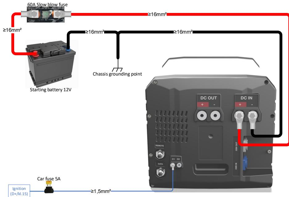
**ADVERTENCIA:** El uso de un tamaño de cable incorrecto o una mala conexión del mismo puede provocar sobrecalentamiento y cortocircuitos.
