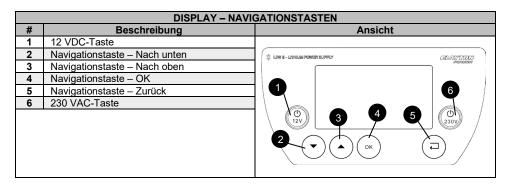
Mit den Tasten 12 VDC und 230 VAC kann der DC- und AC-Ausgang ein- und ausgeschaltet werden. Wenn Sie beide Tasten 10 Sekunden gedrückt halten, wird die LPS II zurückgesetzt, ohne die Einstellungen zu ändern.
