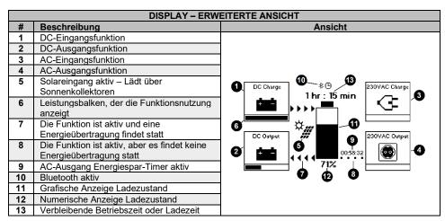
Verwenden Sie die Navigationstasten "Nach oben" und "Nach unten", um zwischen der einfachen und der erweiterten Ansicht zu wechseln.
