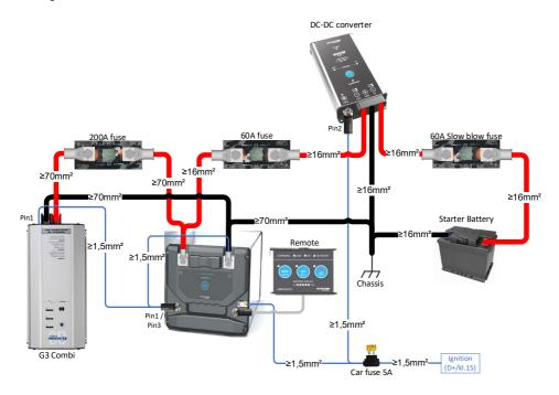
Die Kommunikations-/Steuersignale gemäß der folgenden Tabelle verdrahten:
