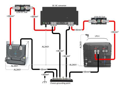
**WARNUNG**: Die Verwendung der falschen Kabelgröße oder eine schlechte Kabelverbindung kann zu Überhitzung und Kurzschluss führen.
