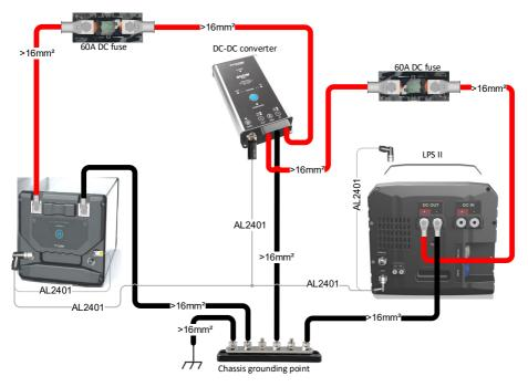
**WARNUNG**: Die Verwendung der falschen Kabelgröße oder eine schlechte Kabelverbindung kann zu Überhitzung und Kurzschluss führen.
