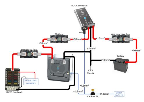
**WARNUNG:** Die Werte der Ausgangssicherung und der Kabelgröße, einschließlich des Erdungskabels, müssen für die verwendete Last ausgelegt sein.
