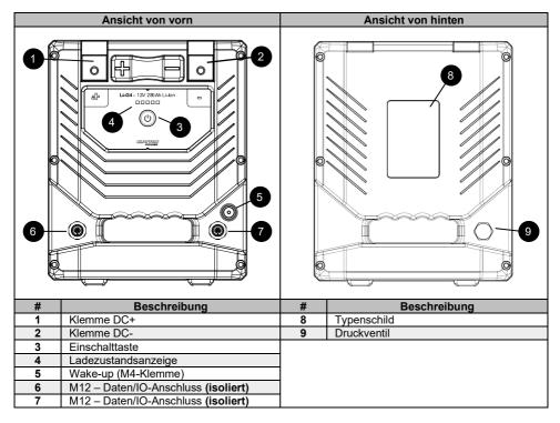
**HINWEIS:** Wake-up (M4-Klemme) ermöglicht die Fernsteuerung der Akkuleistung. Der Akku schaltet sich bei Spannungen über 4 V ein und schaltet sich aus, wenn die Spannung unter 3 V fällt.
